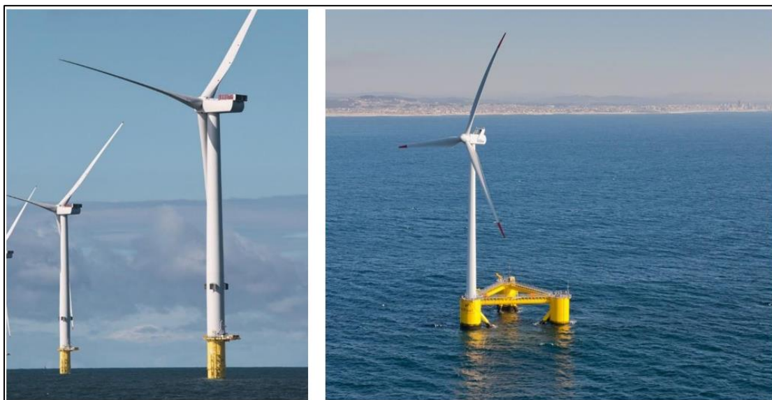
Figura 15. Turbina de cimentación fija y turbina de cimentación flotante
